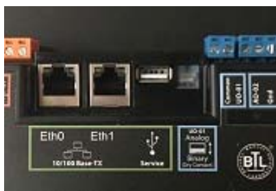
Módulo de Control (con doble Puerto de Monitoreo Ethernet)
