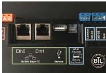
**•Puerto Opcional de monitoreo SNMP (SI):** Adicionalmente cada equipo puede ser monitoreado vía protocolo SNMP mediante puerto TCP-IP.
