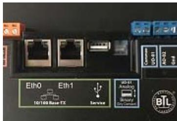
**•Puerto Opcional de monitoreo SNMP (SI):** Adicionalmente cada equipo puede ser monitoreado vía protocolo SNMP mediante puerto TCP-IP.
