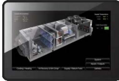
**•Doble puerto de Monitoreo Ethernet:** El módulo de control OPCIONAL (MC) posee doble puerto de conexión BACnet IP de alta velocidad, que permite el monitoreo de absolutamente todas las variables de operación del equipo en tiempo real.
